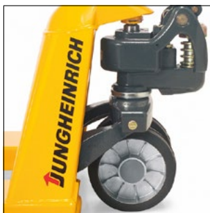
Gruppo idraulico esente da manutenzione
